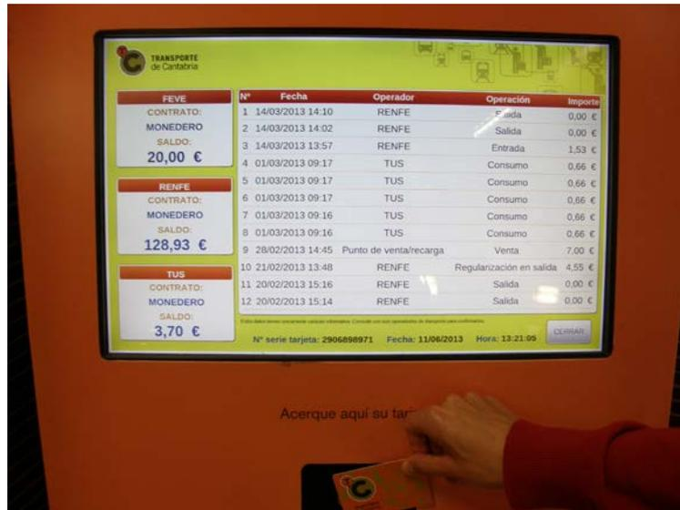
En una segunda fase de la implantación de la tarjeta sin contacto en los servicios de Renfe-Operadora, se instalaron los equipos necesarios en las estaciones del núcleo de Cantabria para su uso como título de transporte, lo que permitía facilitar el uso de la misma y evita el paso por taquilla para adquirir el billete (título de transporte).
